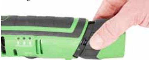
Um den Akku einzusetzen, richten Sie den Akku passend zur Andocköffnung aus. Die elektrischen Kontakte von MultiTool OS10.8 und Akku müssen dabei zueinander ausgerichtet sein. Schieben Sie den Akku langsam in das Gehäuse, bis die Verriegelungen mit einem hörbaren Klicken einrasten.
