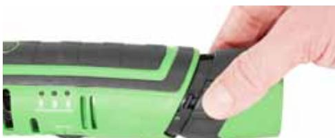
Para encaixar a bateria na ferramenta rotativa, orientar os contatos elétricos da bateria com as partes correspondentes da ferramenta. Empurre a bateria suavemente no compartimento até ouvir o clique de encaixe.
