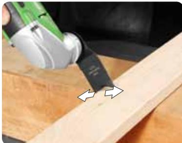
Bewegen Sie das MultiTool OS10.8, wie in der Abbildung zu sehen, kombiniert mit leichtem Druck. Sie werden mit einem sauberer, schnelleren und leicht zu kontrollierenden Schnitt belohnt.
