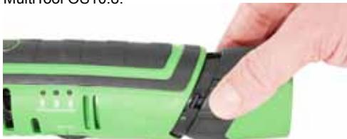
Om de batterij in de MultiTool OS10.8 te plaatsen, draait u de elektrische contacten naar de overeenstemmende delen van de MultiTool OS10.8. Duw de batterij voorzichtig in de behuizing tot u het hoort vastklikken.
