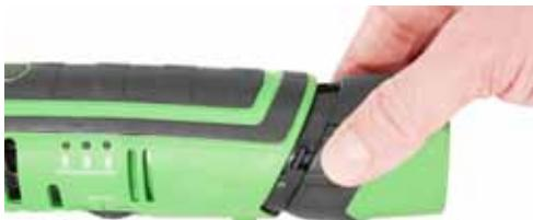
Pour insérer la batterie dans le MultiTool OS10.8, insérez de biais les contacts électriques vers leurs parties correspondantes du MultiTool OS10.8. Appuyez doucement sur la batterie dans le compartiment jusqu'à ce que vous entendiez un « clic ».
